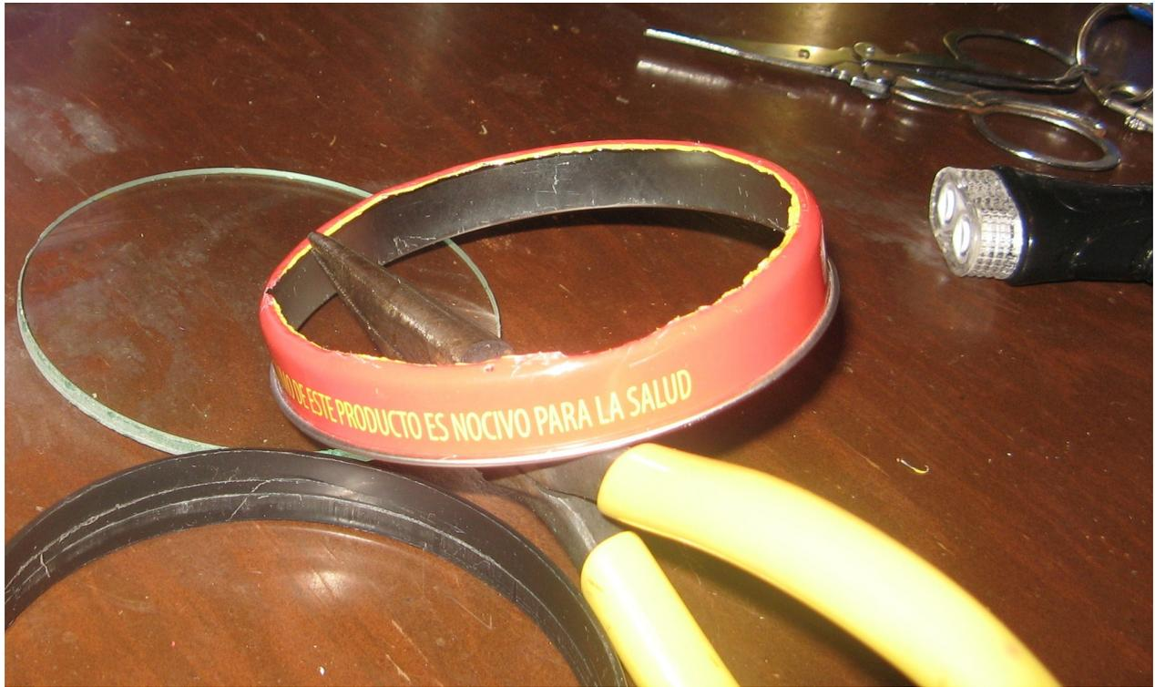
Se coloca silicón negro como se muestra y se procede a colocar la lente de 10cm de diámetro. En seguida se coloca la tapa a la lata.
