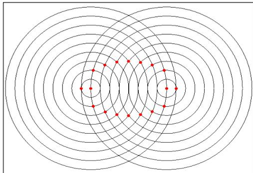
Extrapolando el procedimiento, y prescindiendo de las construcciones auxiliares, se obtiene la elipse siguiente:
